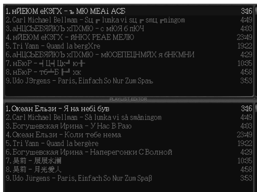
Рисунок 1: Пример использования библиотеки в проигрывателях музыки. Сверху оригинальный XMMS, а снизу XMMS, использующий библиотеку перекодировки.
